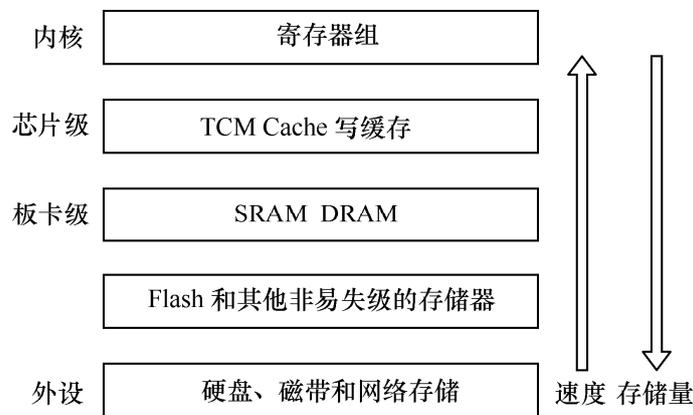
图 2-5 存储器的层次结构
