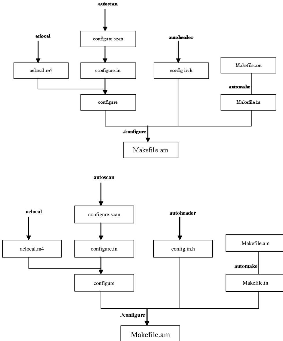
图 3.9 autotools 生成 Makefile 流程图
